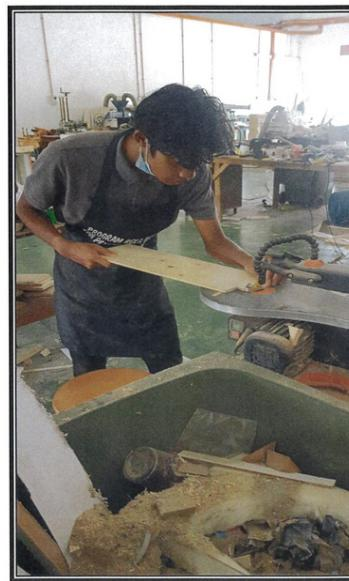
Rajah 7.0 : Abjad lukisan kaca, plastik dan kertas dipotong menggunakan mesin scroll saw
