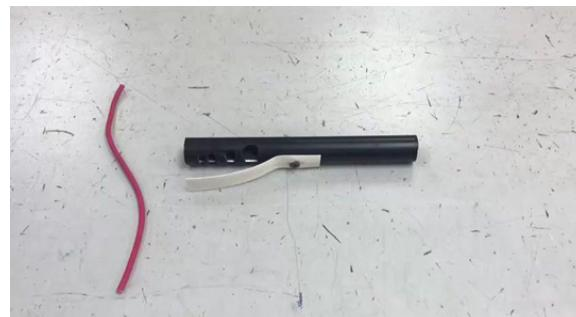
2. Letakkan kabel pada lubang saiz yang bersesuaian dengan saiz kabel yang hendak dijalur.
